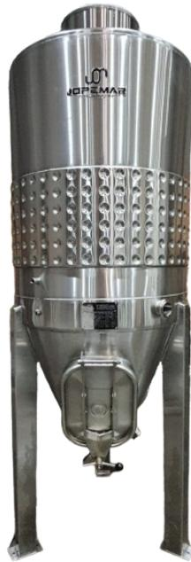
Tanque fermentador de acero inoxidable 304 pulido para fermentación de vino con cinta refrigerante sobre patas, con capacidad de 1500 litros, fondo cónico desplazado y techo cónico de 15°.
