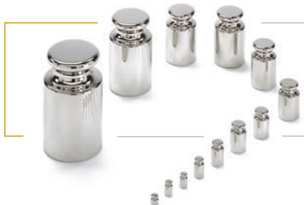
Las pesas de lámina OIML clase F1 con valores nominales de entre 1 mg y 5 mg están fabricadas en aluminio con una densidad de 2.650 kg/m<sup>3</sup> y las pesas con valores nominales de entre 10 mg y 500 mg de aleación de níquel plata con una densidad de 8.600 kg/m<sup>3</sup>. Las tolerancias cumplen con OIML R111-1.
